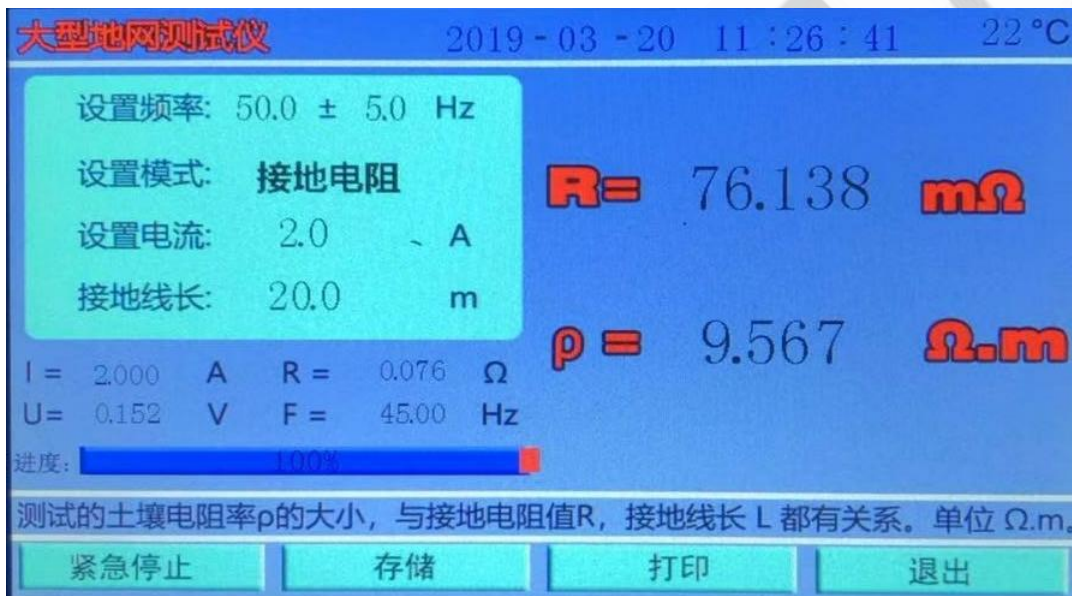
(图 16) 接地电阻测试结果界面
