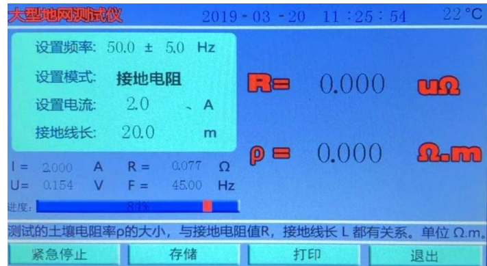
(图 15) 接地电阻测试界面
