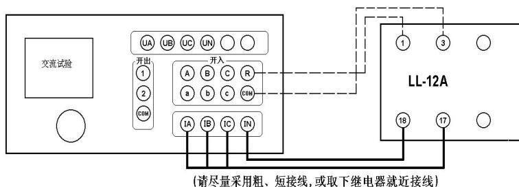
返回值及动作时间和返回时间，计算返回系数。下图为 LL-12A 过电流继电器的接线图。
