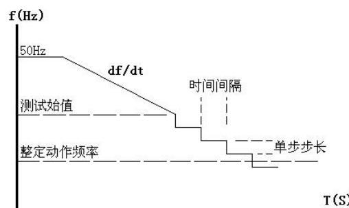
这里逐格变频的时间间隔是根据整定的动作时间自动确定的，该时间间隔比整定动作时间长0.2S。故整定动作时间应设置正确，以保证在变化时间间隔内保护有足够时间可以动作。
