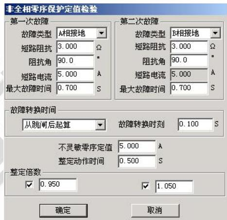
第二次故障的出现时刻可以设定。可选择从第一次跳闸后起算何时出现，也可设定从第一次故障开始时起算何时出现。设定时刻到将自动输出第二次故障。若保护的重合闸功能未退出，则该时刻应设置为重合闸时间未到时。
