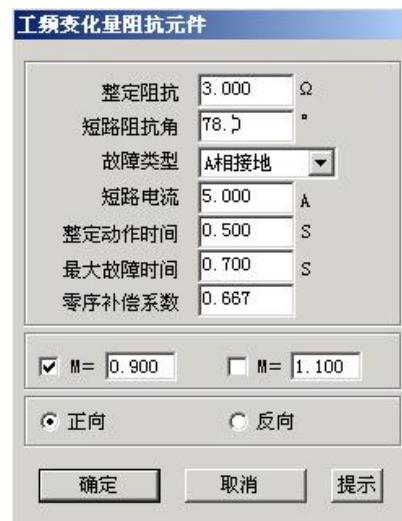
“短路电流”参数应设置得大一些，建议 10~20A，因为短路电流太小，根据上述公式计算
