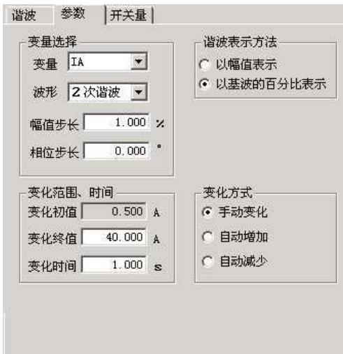
切换至“参数”页面，选择 IA 为变量，波形为“二次谐波”，并设幅值步长为 1%，选择“手动变化”方式。设置好的参数如上图所示。开始试验，按步长逐步减小变量致保护动作。将动作时 IA 的二次谐波百分比值与整定的制动系数对照。
