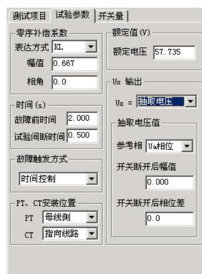
障触发方式。本模块提供了“时间控制”、“按键触发”、“开入 c 触发”和“GPS 触发”四种触发方式。
